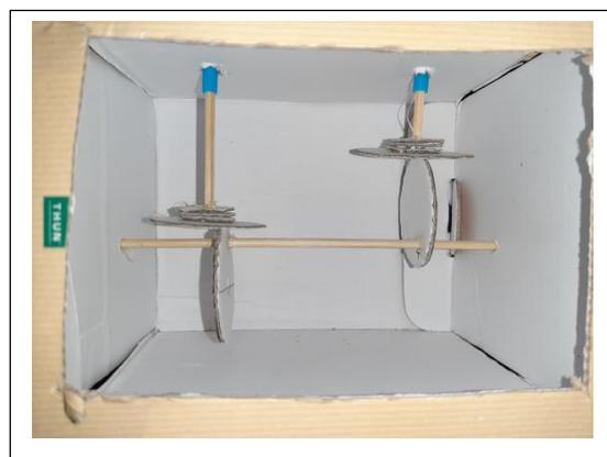
Forate le camme con lo spiedino, poi inserite l'albero (asse orizzontale) e le camme. Fissatele con la colla o con lo scotch (proprio come ho fatto io nella foto a destra). Fissate i due pezzi di cannuccia sui fori della parete superiore e dall'interno della scatola inserite i seguitacamma, appoggiandoli sulle camme.
