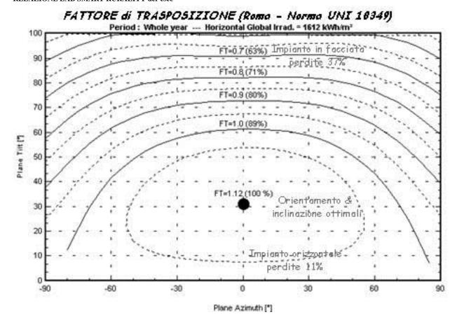
Tale figura aiuta a stimare la perdita di energia che si deve mettere in conto qualora l'orientamento e l'inclinazione dei moduli differiscano da quelli ottimali (FT=1,12).
